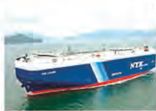
IRIS LEADER 総出力: 7,000kW (約9,500馬力) ZURC6LSE-650-A2
