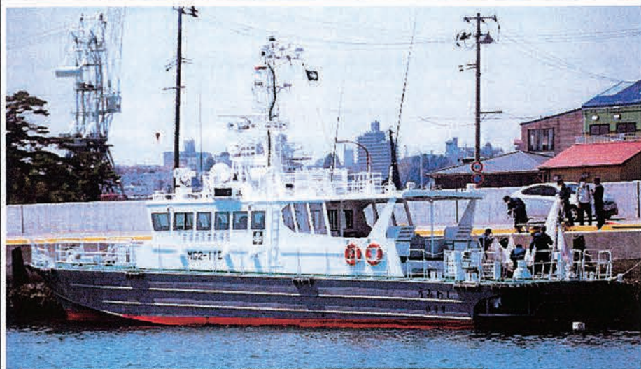
宮城県漁業取締船「うみわし」(65ト) 釜石港にて撮影 漁業取締船としては国内最速の45ノット以上を誇る。
