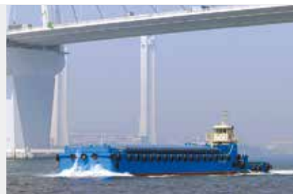
プッシャー：長生丸 全長17.5m／幅5.5m バージ：扇翔 全長38.5m／幅8m
