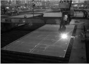
鉄板の切り出し
