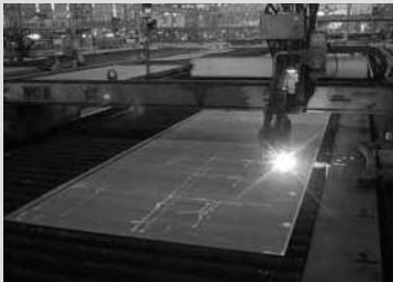
鉄板の切り出し
