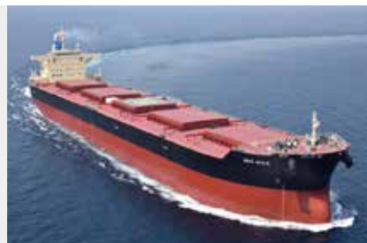
IRIS WAVE 49,905総トン／88,769重量トン／全長230m
