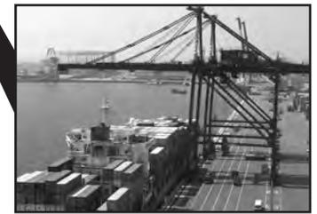
コンテナを積みおろすための大きな<sup>かんとりー</sup>ガントリークレーンがあり、コンピューターで管理されています。
